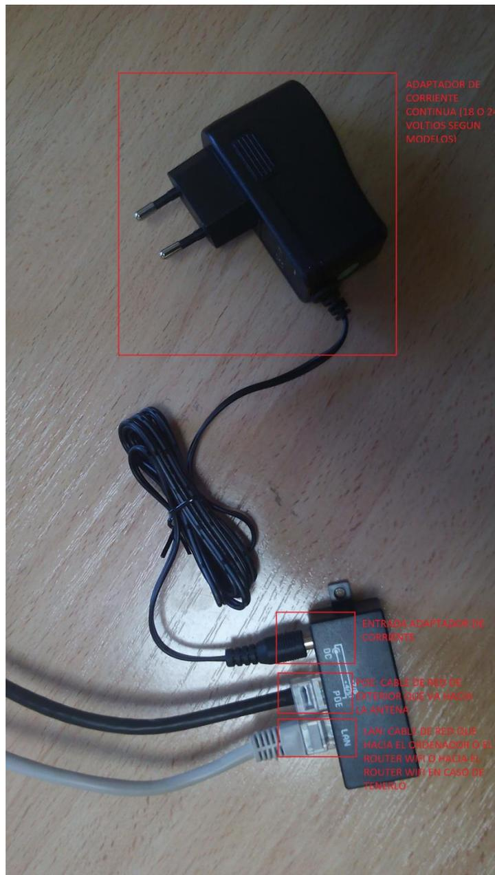
En el caso de disponer de router el cable que va de la LAN de todos los modelos de POES anteriores iría conectado a las bocas de color amarillo del router en caso de ser nuestro, en el caso de que el router no sea nuestro deberá de ir conectado a cualquier boca del grupo de la LAN (nunca en la WAN), se quedaría de la siguiente forma:
