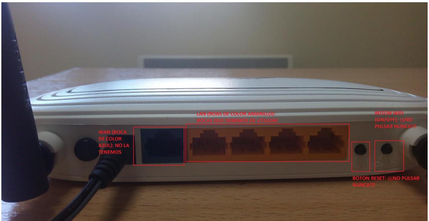
En caso de que la conexión de internet nos falle debemos de conectar el cable que viene directo de la LAN de la antena (el mismo conector que está metido en el router) y conectarlo directamente a la tarjeta de red de nuestro ordenador para descartar que el problema pueda ser el del router.
