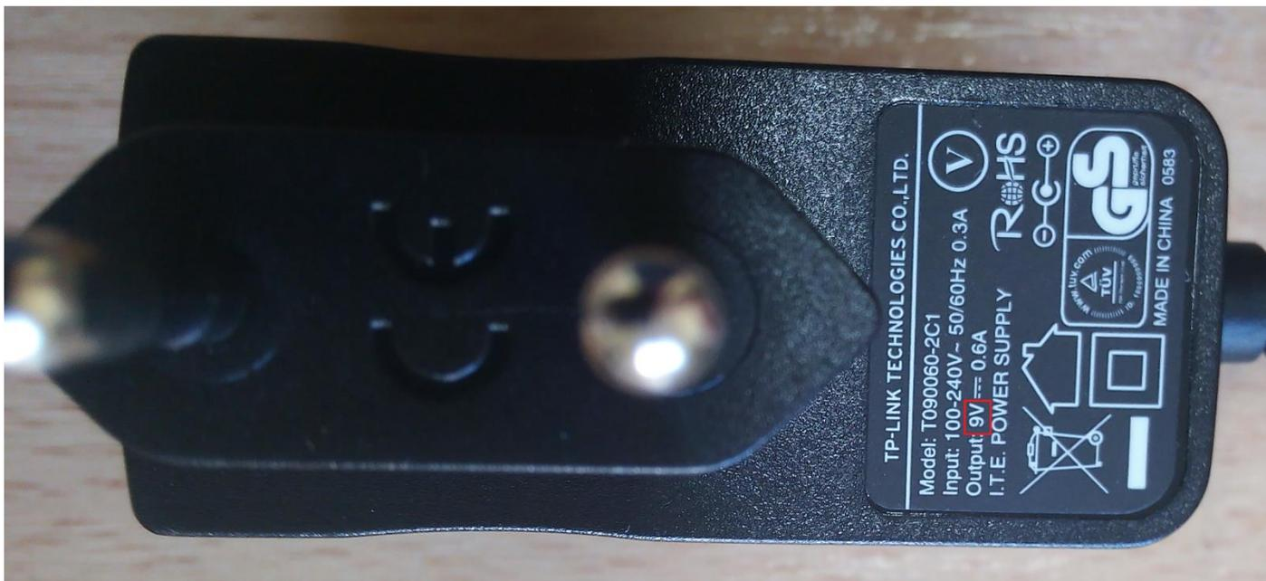
Tal y como comente anteriormente es importante no mezclar los adaptadores de corriente del router WIFI y de la antena, ya que si lo hacemos la antena no funcionara porque estará alimentada a menos voltaje y el router WIFI lo romperemos porque le pondremos lo alimentaremos a mas voltaje al ponerle el adaptador de corriente de la antena.
