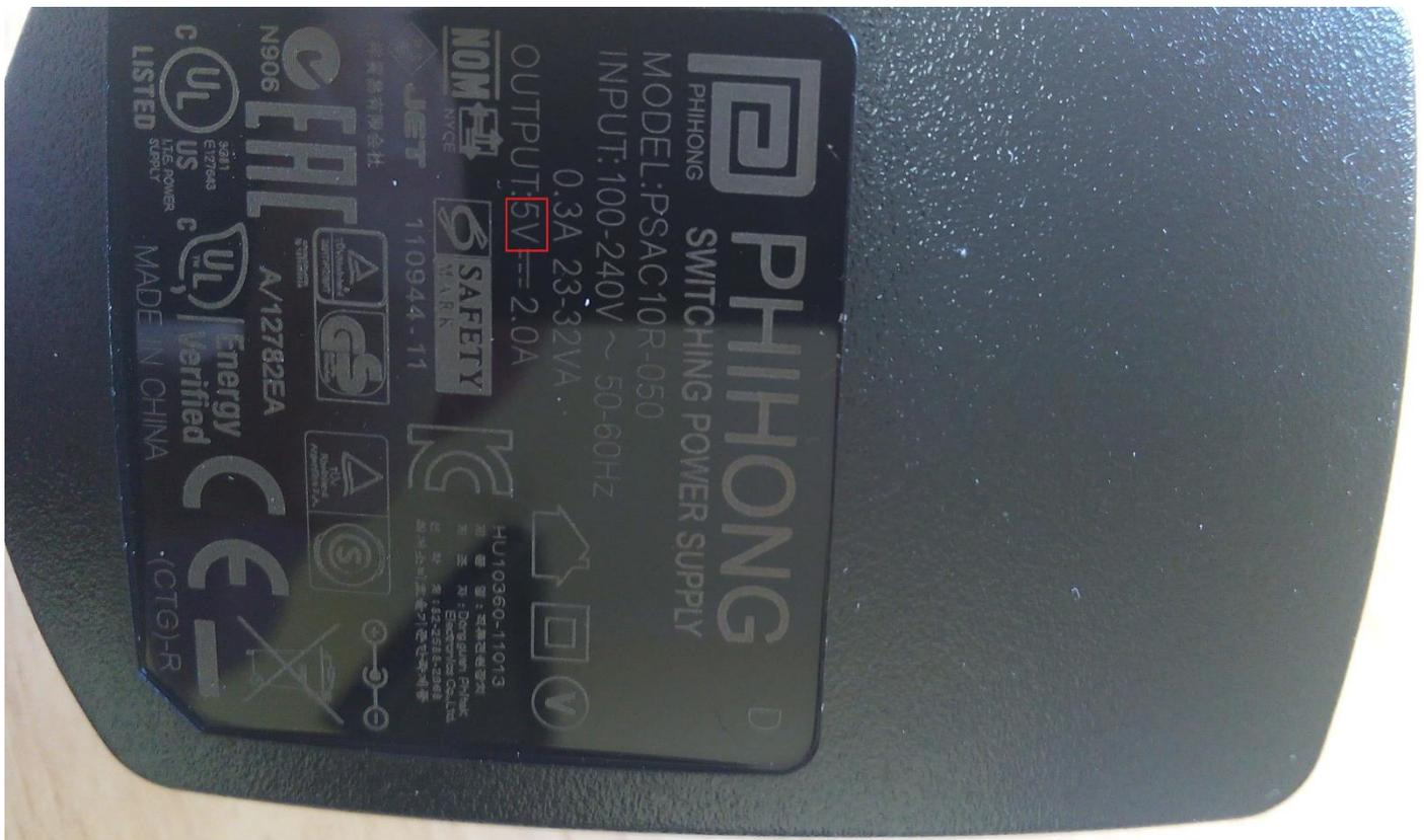
En cuanto al adaptador de corriente comento lo mismo que con el adaptador del router WIFI: es importante no mezclar los adaptadores de corriente del ATA y de la antena, ya que si lo hacemos la antena no funcionara porque estará alimentada a menos voltaje y el ATA lo romperemos porque le pondremos lo alimentaremos a mas voltaje al ponerle el adaptador de corriente de la antena.
